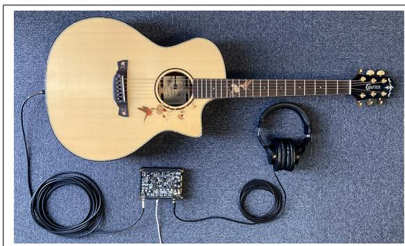
**Figure 2.** Prototipo del classificatore di tecniche espressive. Il segnale audio dei pickup della chitarra viene passato ad un Raspberry PI 4 tramite un interfaccia audio (Elk PI Hat). Il risultato della classificazione viene comunicato tramite le cuffie con dei semplici toni (sinusoidali) con una diversa frequenza in base alla tecnica espressiva usata.
